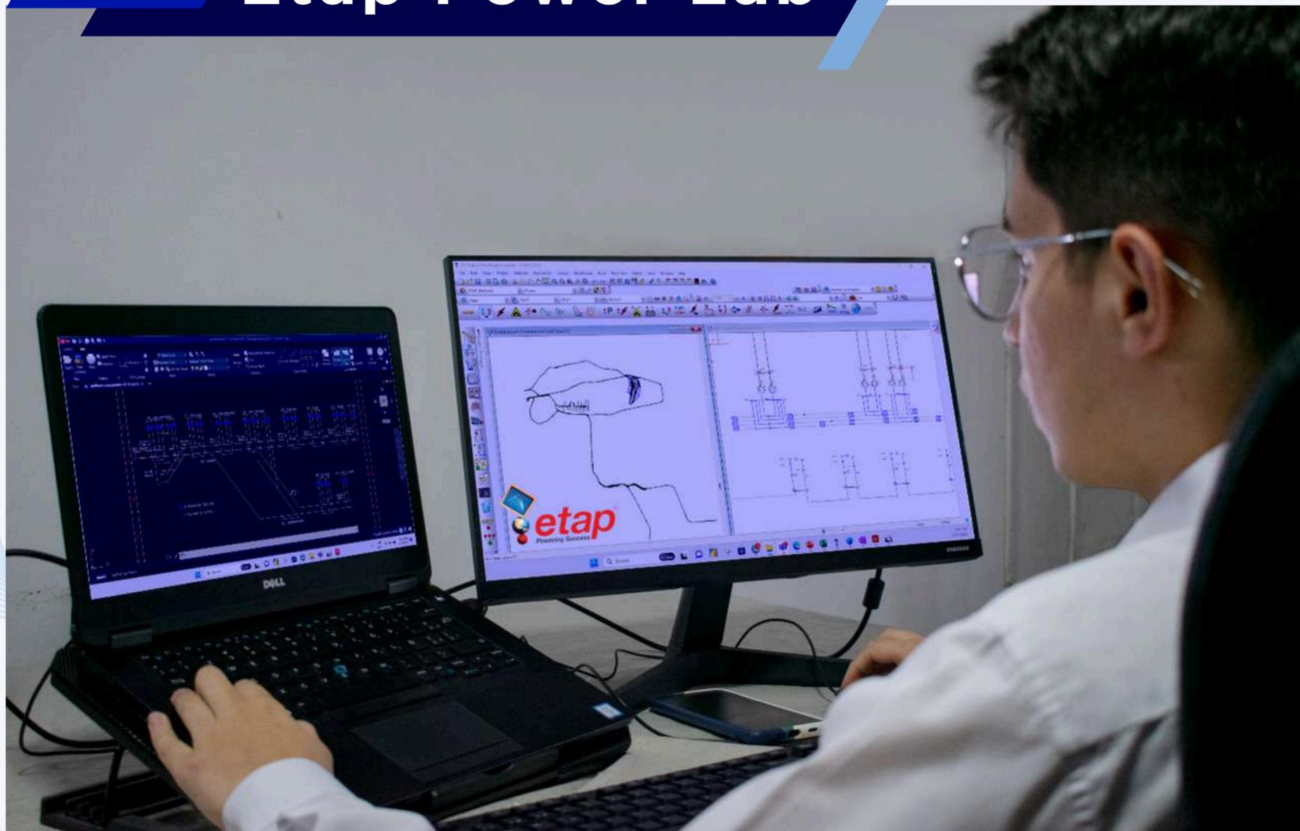
Es un software de análisis y simulación de sistemas eléctricos basado en RMS, que modela y simula redes eléctricas de manera precisa. Permite a los usuarios realizar estudios complejos como flujos de carga, cortocircuitos, coordinación de protecciones, entre otros, optimizando el diseño y la operación de sistemas eléctricos. La versión PowerLab permite a las universidades acceder a estas funcionalidades en un entorno educativo.
