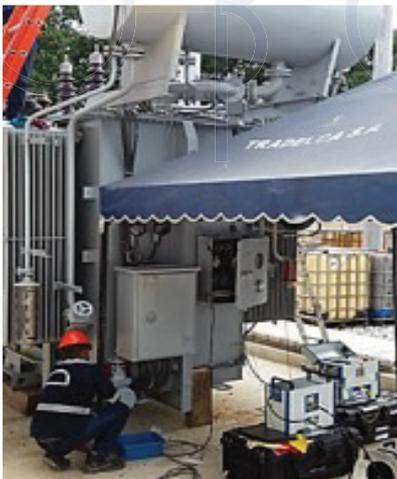
Evaluamos el estado de los transformadores de potencia y distribución, determinamos la relación de transformación, la resistencia de los devanados, la corriente de excitación, la impedancia de corto circuito, la resistencia de aislamiento, la capacitancia y el factor de potencia.
