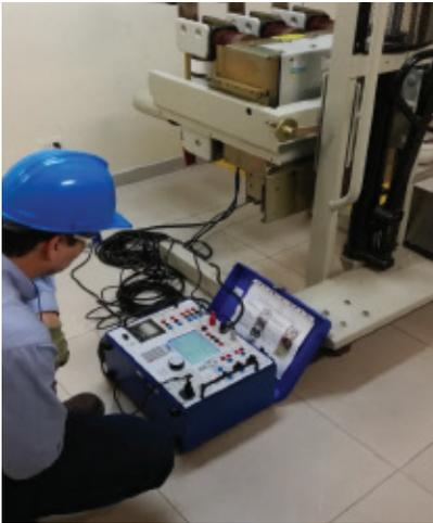
Evaluamos el adecuado funcionamiento de los interruptores de potencia en todos los niveles de tensión, detectando desviaciones con las especificaciones del fabricante, que puedan causar omisiones de disparo en su sistema.
