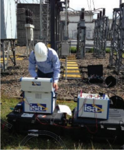
Damos un concepto técnico del estado del sistema de puesta a tierra, minimizando la probabilidad de daño en equipos (variadores de velocidad, UPS, servicios auxiliares) o accidentes laborales por choque eléctrico, contacto directo o indirecto.
